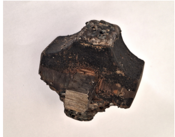
(B) Rotor MRS après soudage et polissage
