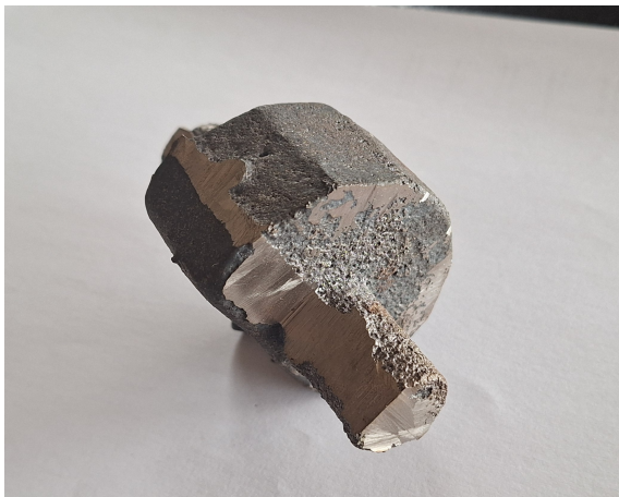
(A) Rotor MSAP métal inachevé
