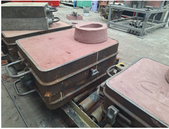
FIGURE 11 – Moule avant et après la coulée au lycée LORITZ.
